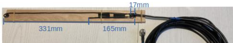
Afgebouwde antenne, met maten volgens calculator
